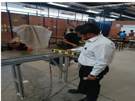
Figura 9. Nivelación y calibración de las bandas.
