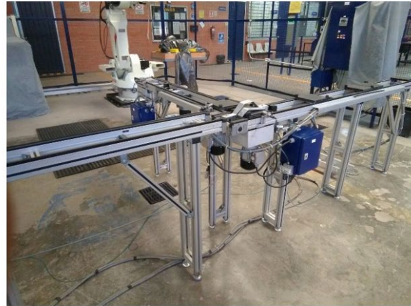
Figura 2. Sistema que conforma a la banda de manufactura flexible.
