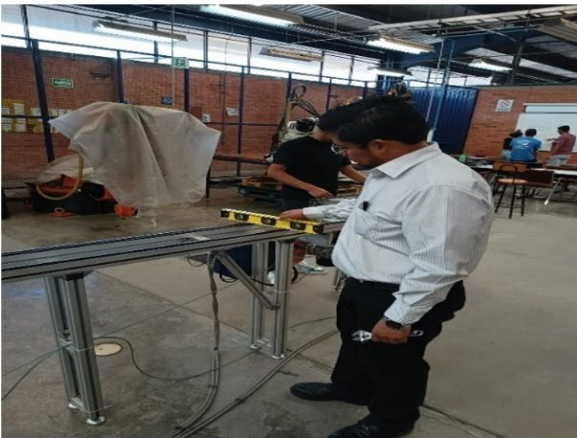
Figura 9. Nivelación y calibración de las bandas.
