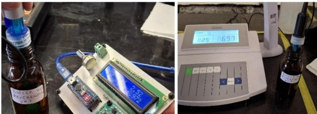
Figura 12. Medición de solución buffer de pH 7.0. Izquierda: con medidor prototipo. Derecha: con medidor de la marca Science Med (Elaboración propia).
