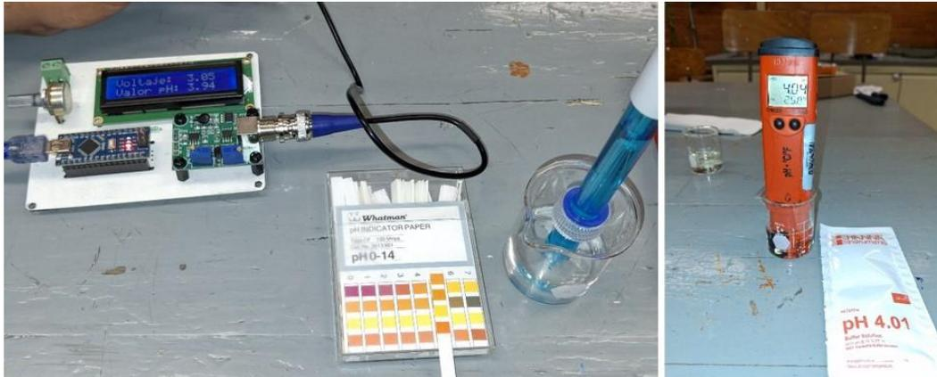
Figura 13. Medición de solución buffer de pH 4.01. Izquierda: con medidor prototipo y tira reactiva de pH. Derecha: con medidor HI98127 (Elaboración propia).
