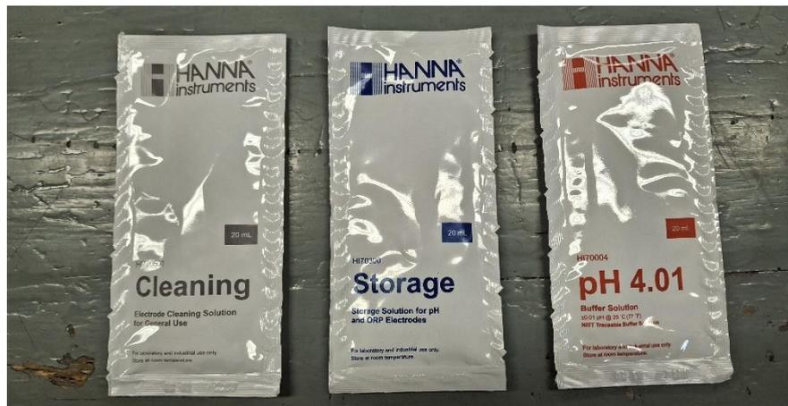
**Figura 2. Izquierda: Solución de limpieza de propósito general. Centro: Solución de almacenamiento. Derecha: Solución de calibración pH 4.01. Soluciones de la marca Hanna.**
