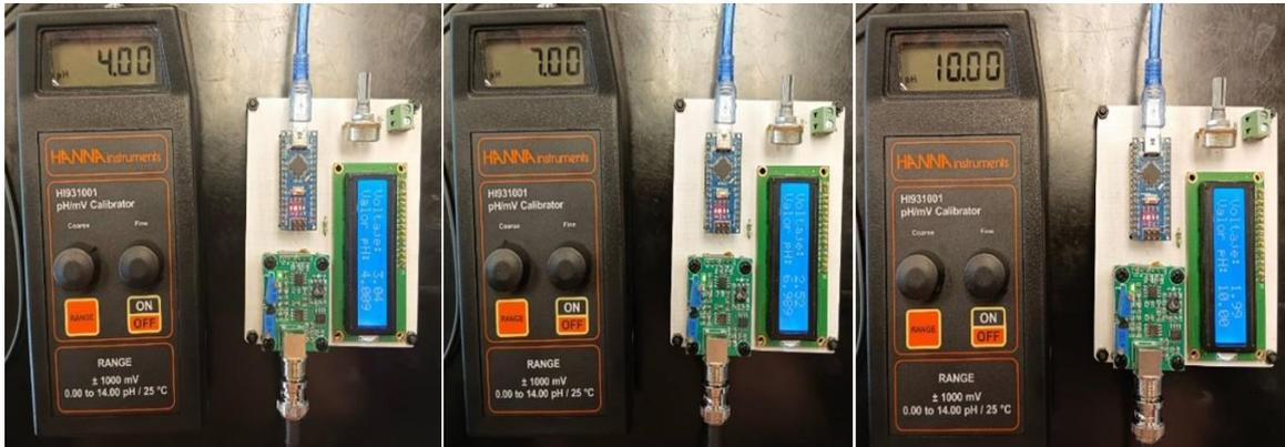
Figura 11. Calibración de medidor de pH mediante calibrador H1 931001 (Elaboración propia).
